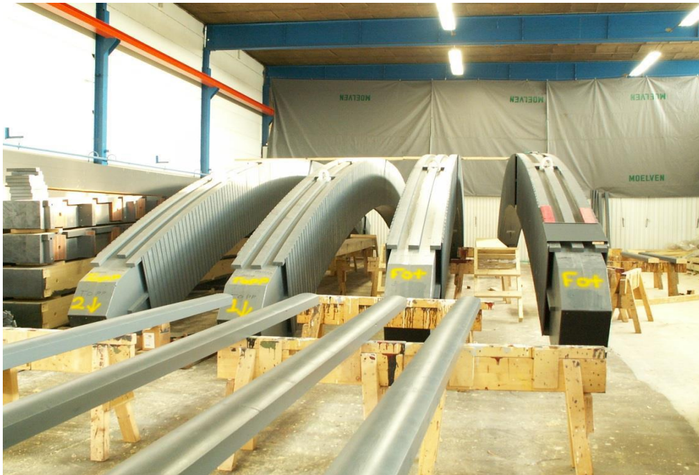
Kuva 29. Kaaret valmistetaan tehtaalla [1].
